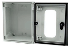
Cutie distribuție pentru aplicații industriale, 140 x 300 x 250 [mm], IP66, material fabricație poliester.
